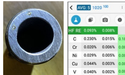
Figure 3 SciAps Z-902 Kohlenstoffanalyse eines 1" s/160 A106 Rohnrippels für den HF- Alkylierungsservice
