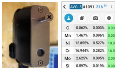
Figure 4 SciAps Z-902 Kohlenstoffanalyse von 1/8" Draht, Material 316L
